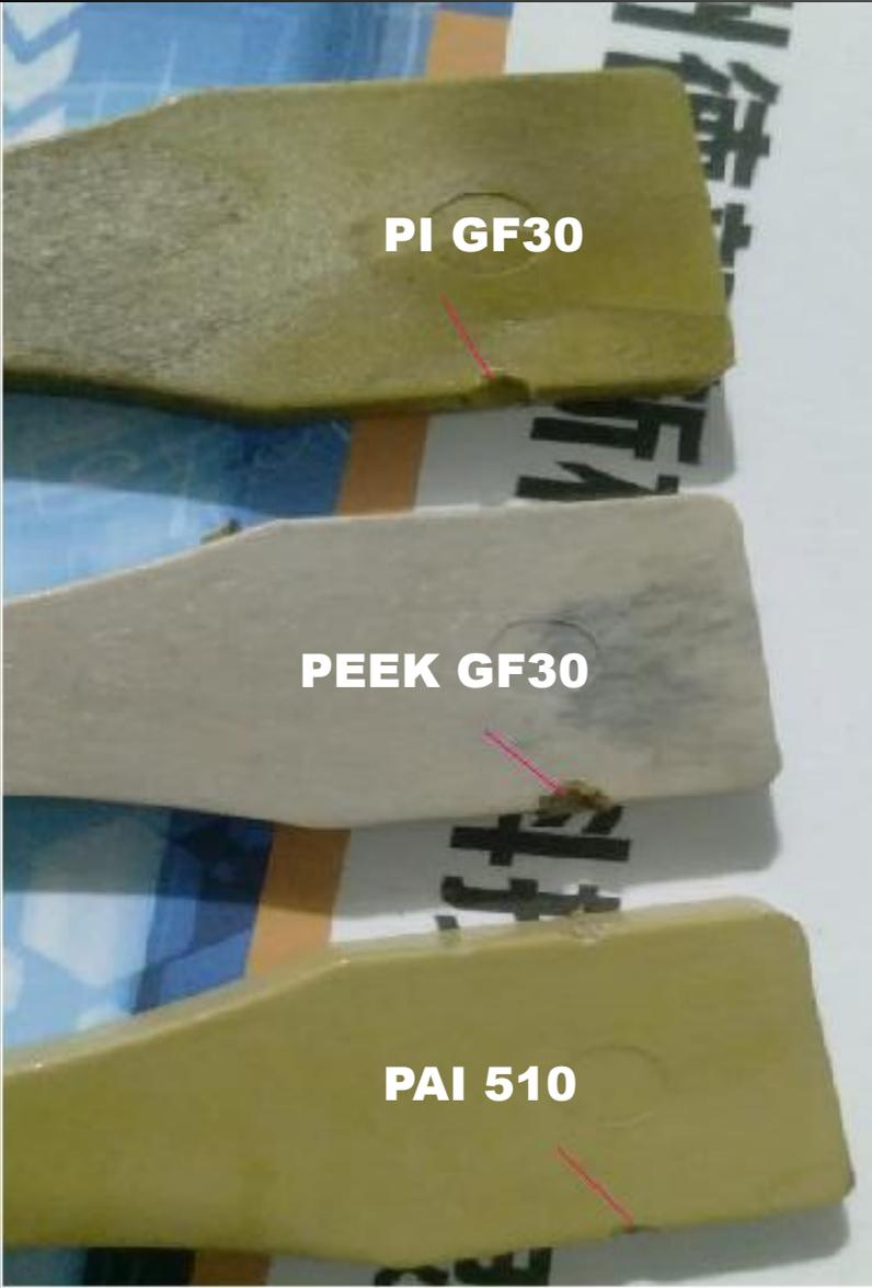
300度电烙铁压痕状态
